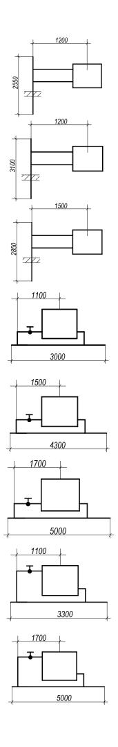
Определить монтажные и заготовительные длины трубопроводов. Трубы стальные водогазопроводные по ГОСТ 3262-75\*. Радиатор М-140A, установлен у стены, количество секций — 5. Способ соединения трубопроводов — на сварке. Диаметр разводящей магистрали 32 мм, подводок — 25 мм. Кран пробковый бронзовый.
