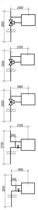
Определить монтажные и заготовительные длины трубопроводов. Трубы стальные водогазопроводные по ГОСТ 3262-75\*. Радиатор М-140A, установлен в нише, количество секций – 8. Способ соединения трубопроводов – на резьбе. Диаметр стояка 20 мм, подводок – 15 мм. Вентиль бронзовый.
