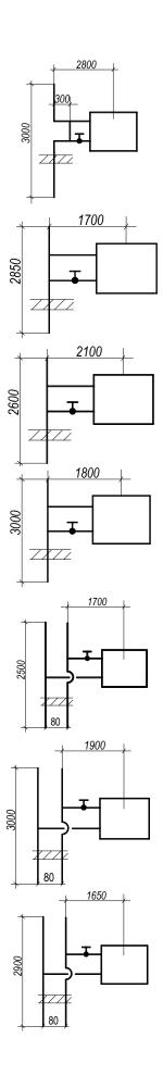
Определить монтажные и заготовительные длины трубопроводов. Трубы стальные водогазопроводные по ГОСТ 3262-75\*. Радиатор М-140A, установлен у стены, количество секций — 5. Способ соединения трубопроводов — на сварке. Диаметр стояка 32 мм, подводок — 25 мм.
